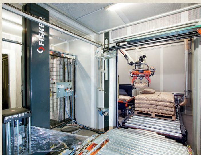
Rullebaner fra container med palleterer og ind i container med fuldautomatisk vikler.
