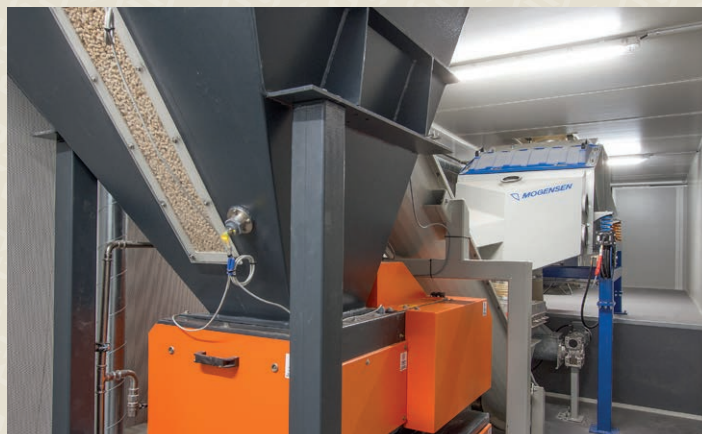
Sigte forbundet med snegl til vægt.
