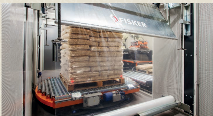
Fuldautomatisk strækfolievikler. Når pallen er færdigviklet, vil den køre videre til den sidste container, klar til afhentning.
