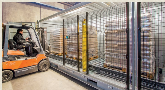
Når der er tre færdige paller i den sidste container, stopper vik- leren. Så snart den yderste palle er afhentet, starter en fotocelle rullebanerne, de to øvrige paller flyttes til enden, og vikleren starter igen. Sikkerhed med hegn og lysbarriere helt som i et sædvanligt anlæg.
