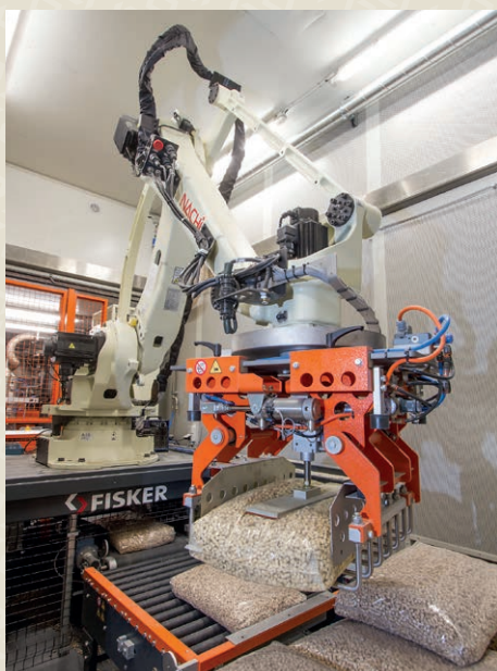
Palletering af sække med Nachi robot-palleterer.
